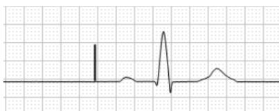
Ist die Option **Erkannte Schrittmacher durch künstlichen 1 mV-Impuls verdeutlichen** eingeschaltet, wird die Position des Schrittmacherspikes ins EKG eingeblendet.
