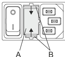
Der Sicherungshalter (A) mit den Netzeingangssicherungen befindet sich neben dem Netzschalter.
