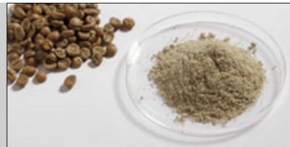
Rohkaffee vor und nach der Mahlung mit der P-14 und Siebring 1 mm Trapezloch bei 20.000 U/min
