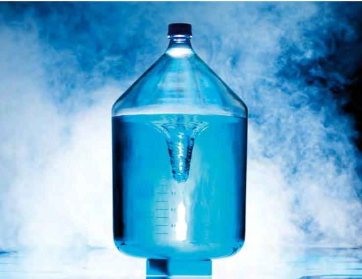
Sehr kräftige Magnetskopplung, daher prädestiniert für Kraftübertragung über größere Distanzen oder für dicke Gefäßböden. Wartungsfreier 2mag-Motor-Antrieb mit breitem Drehzahlbereich von 100 bis 1.200 rpm.
