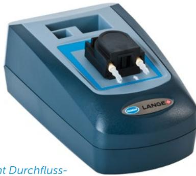
Der Rechteckküvetten-Schacht lässt sich zu Reinigungszwecken einfach vom Anwender wechseln.
