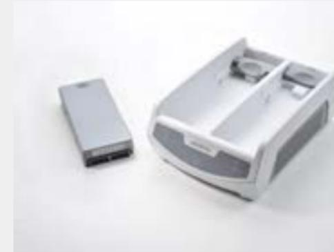
Der BeneHeart D1 mit Lithium-Ionen-Akku für mehr als 300 Schocks mit 200 J oder 200 Schocks mit 360 J und 12 Stunden Überwachung. Mit dem externen Ladegerät wird der Reserveakku geladen und bereit für den Einsatz gehalten.
