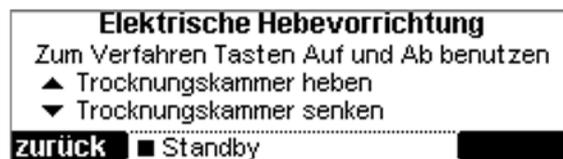
Abb. 34: Bedienung der elektrischen Hebevorrichtung
