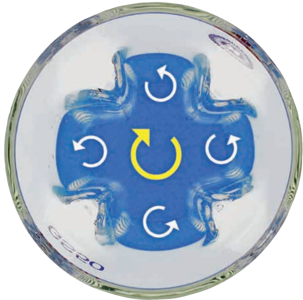
Prinzip der GS-Behälter (von oben betrachtet)
