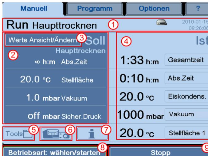
Abb. 78: Bedienoberfläche LSCplus
