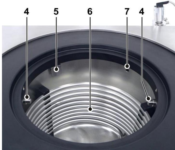
Abb. 3: Eiskondensatorkammer
