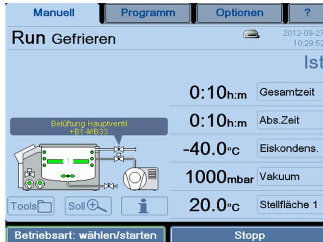
Abb. 24: Darstellung eines Anlagenschemas mit Bezeichnung und Betriebsmittelkennzeichen
