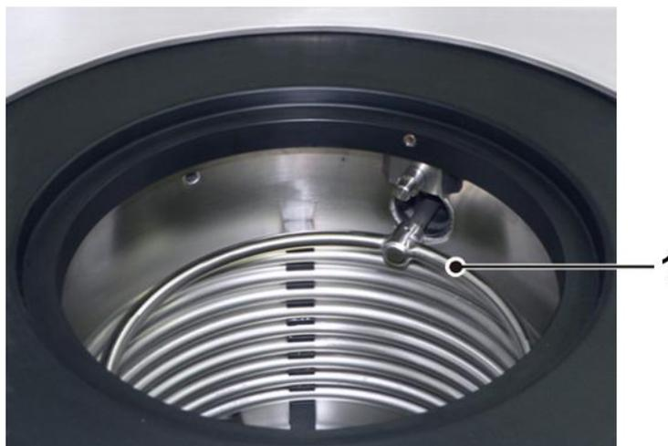
Abb. 10: Eiskondensatorkammer mit Warmwasserabtauung
