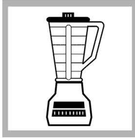
2. Homogenisieren Sie die Probe in einem Mixer, falls diese große Festteilchen enthält, die sich ablagern oder in der Flüssigkeit schwimmen können.
