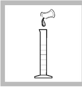
**4.** Fügen Sie dem Inhalt des Messzylinders den Inhalt eines Nährstoffpufferkissens hinzu.
