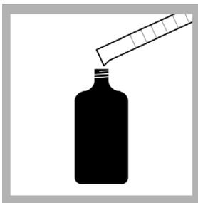
6. Füllen Sie die so vorbereitete Probe aus dem Messzylinder in eine BODTrak II Flasche.
