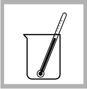
1. Erwärmen oder kühlen Sie die Probe auf 19 bis 21 °C (66 bis 70 °F).
