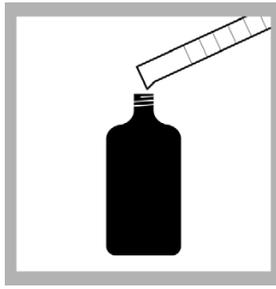
**5.** Füllen Sie den Inhalt aus dem Messzylinder in eine BODTrak II Flasche. Für weitere Proben wiederholen Sie die Schritte 1 bis 5.
