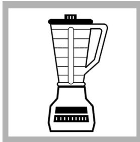
2. Homogenisieren Sie die Probe in einem Mixer, falls diese große Feststoffteilchen enthält, die sich ablagern oder in der Flüssigkeit schwimmen können.
