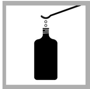
**3.** Geben Sie mit einem Spatel 2 Kaliumhydroxidpellets in den Verschlusseinsatz. Wiederholen Sie die Schritte 1 bis 3 für jede Probenflasche.
