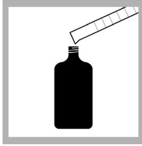
8. Füllen Sie die so vorbereitete Probe aus dem Messzylinder in eine BODTrak II Flasche.
