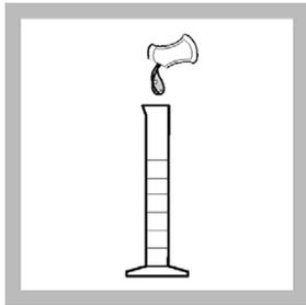
4. Fügen Sie dem Inhalt des Messzylinders den Inhalt eines Nährstoffpufferkissens hinzu.
