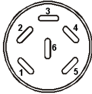
Abbildung 21: Pinbelegung der DIN Buchse (6)
