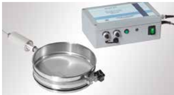
Analysensieb mit Spannring, Konverter und Generator.
